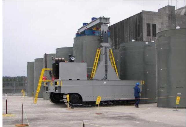
Figure 32 : Photo d'un entreposage utilisant le concept HI STORM 100
