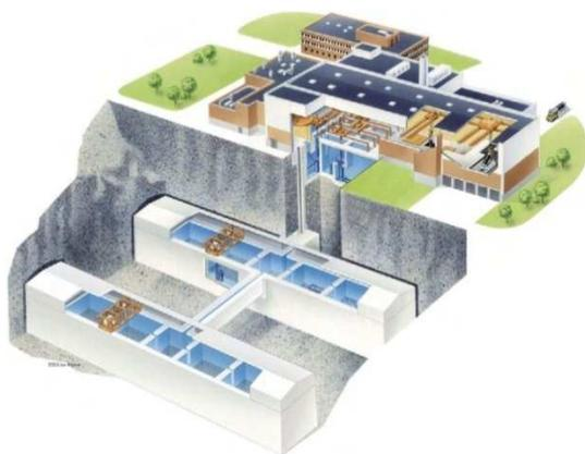
Figure 12 : Vue écorchée de l'installation CLAB à Oskarshamn (Suède)
