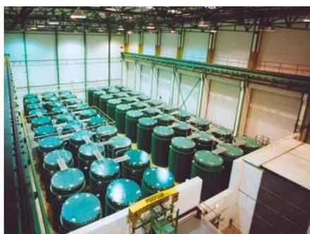
Figure 53 : Entrepôt en emballages CASTOR® sur le site de la centrale de Dukovany (Rép. Tchèque)
