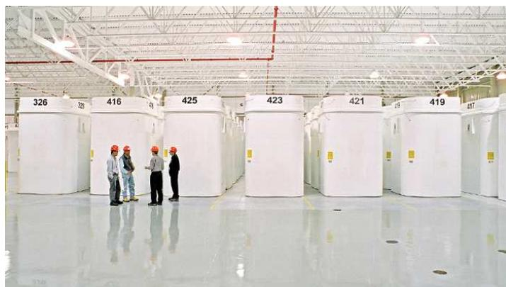
Figure 56 : Photo d'un entreposage en emballages béton développés par la société OPG
